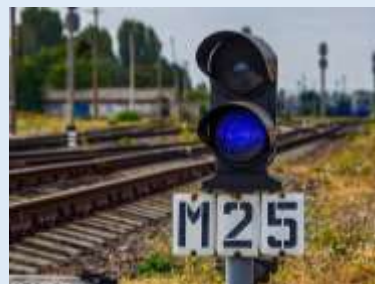
Fig.3.2- Semafoarele pitici (de expediere și de manevră)
