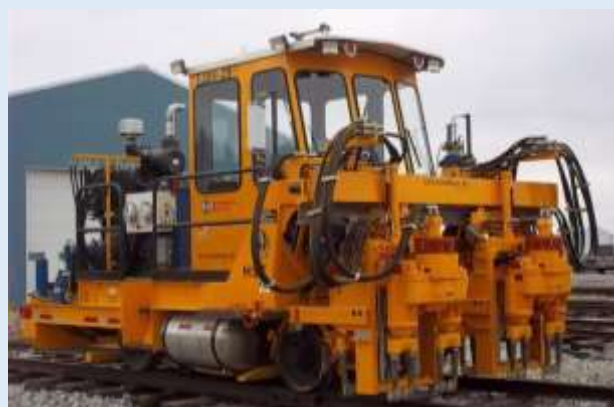
Fig.2.50- Mașina de cale Hydraulic Switch Tamper pentru burare a căii
