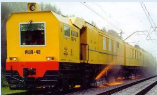
Fig.2.53- Vagon de șlefuire a șinelor (PIИП)
