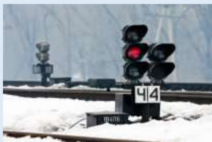
Fig.3.2- Semafoarele pitici (de expediere și de manevră)
