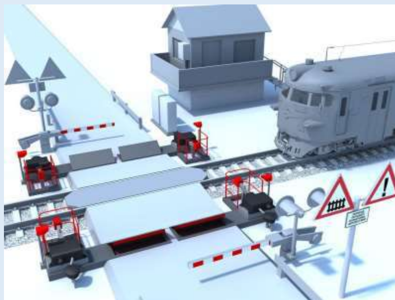
Fig.2.38 – Echipamente pasajului feroviar
