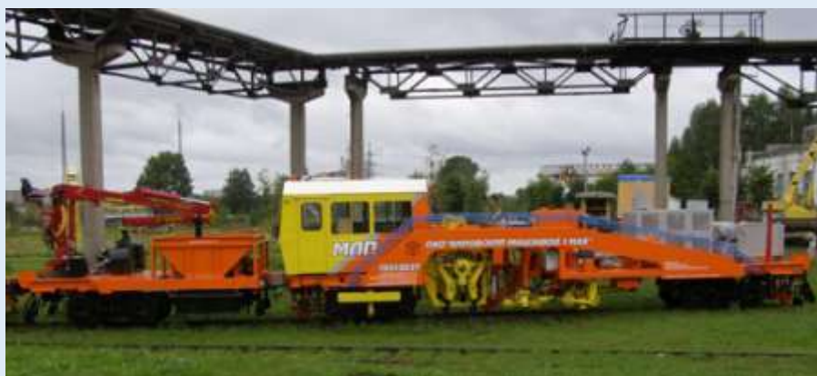
Fig.2.47- Mașina pentru rectificare a căii
