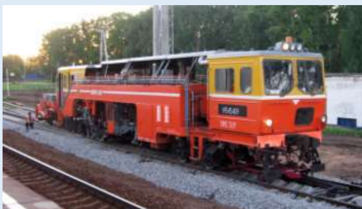
Fig.2.45- Mașina de rectificare și burare a căii (VPRS-3)
