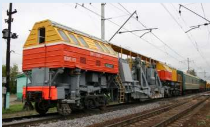
Fig.2.46 - Mașina de rectificare, burare și finisare a traseului (BΠO-3000)
